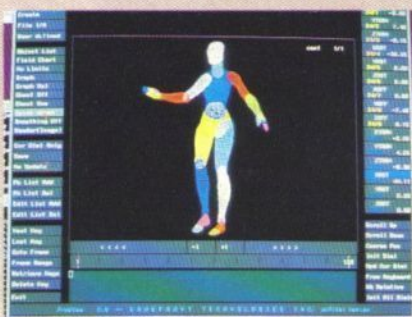
"L'osso iliaco è collegato al femore..." Ora completamente modellato il corpo consiste di 31 elementi grafici ognuno con la propria geometria e caratteristiche di movimento. Gli animatori lavorano su spezzoni di film e su proprie coreografie per determinare i movimenti degli arti. Le sottigliezze della dipendenza del movimento (il movimento della spalla quando il braccio è alzato, ad esempio) possono fare una grande differenza ai fini del realismo dell'animazione della figura.
